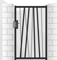
VERSION N.° 3 Barreaudage non débordant entre traverses
